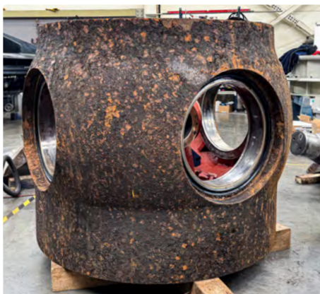
Fot. 5. Piasta wirnika: po demontażu, po oczyszczeniu, po malowaniu preparatem epoksydowym
