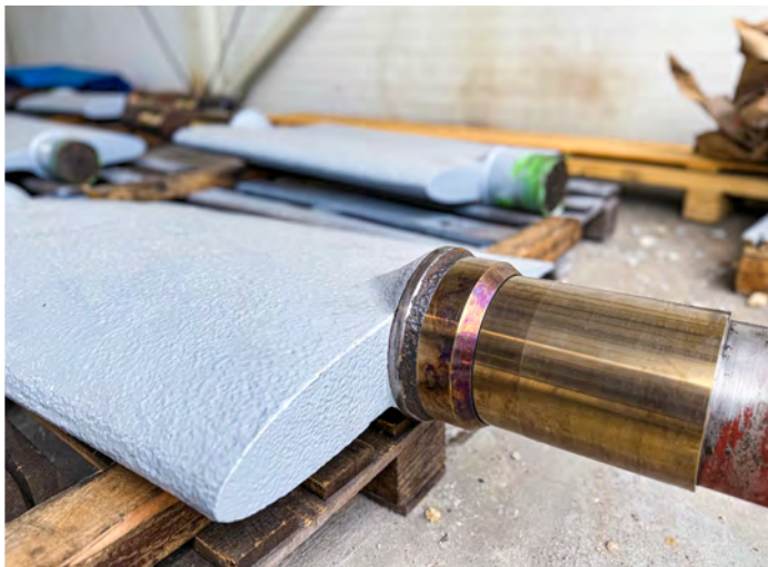
Fot. 9. Widok na skorodowane przejście czopu w płat łopaty oraz widok na zregenerowany detal
