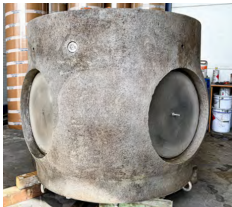
Fot. 5. Piasta wirnika: po demontażu, po oczyszczeniu, po malowaniu preparatem epoksydowym
