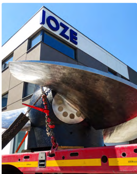
Fot. 6. Wyjazd wyremontowanego urządzenia z zakładu IOZE hydro
