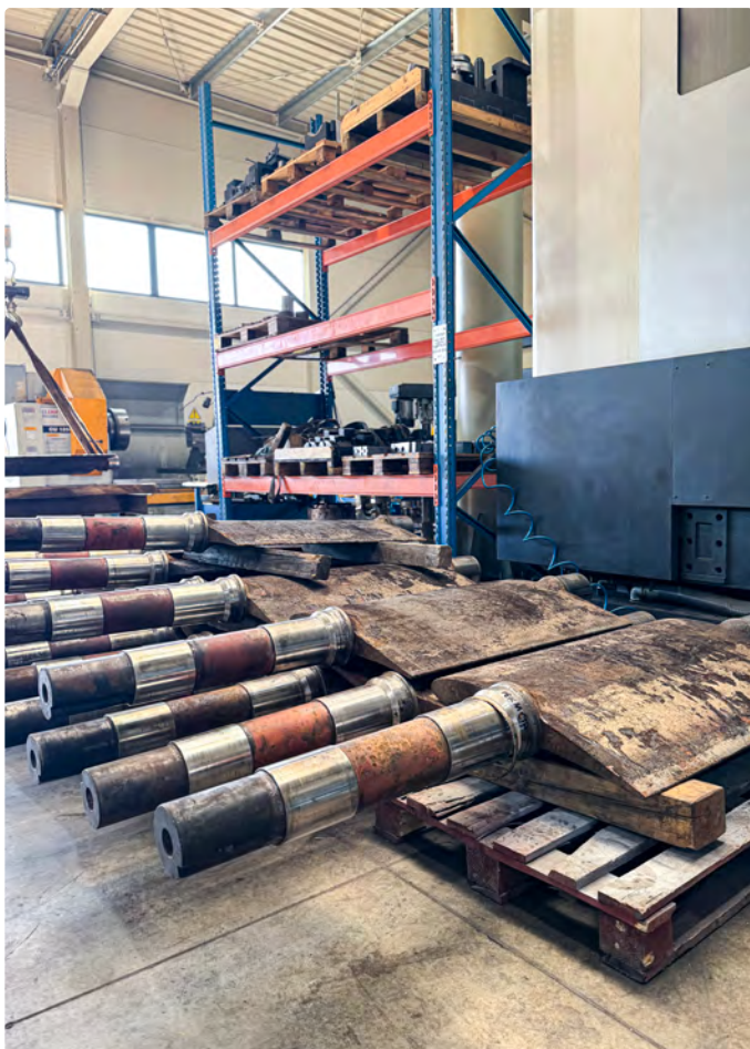
Fot. 10. Łopaty aparatu kierowniczego przed remontem
