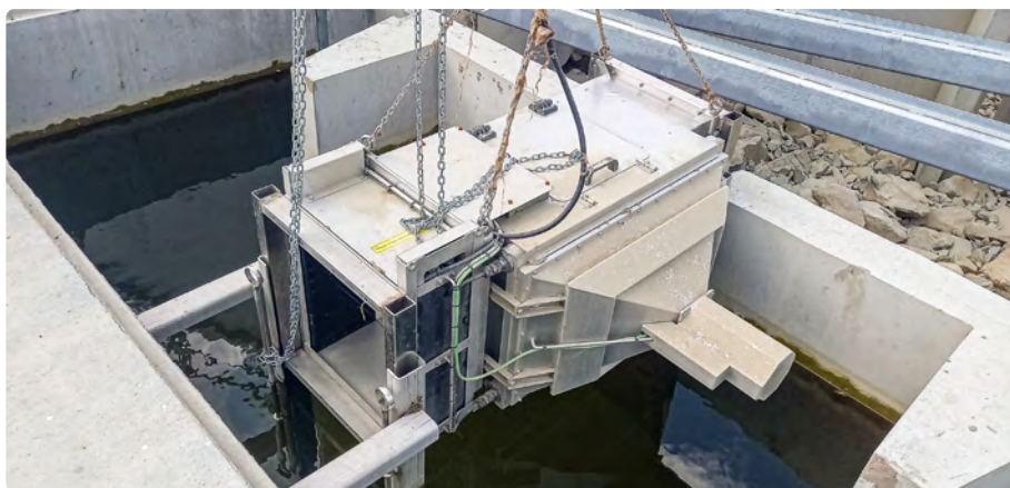
Fot. 2. Riverwatcher Vaki – urządzenie do wizualnej rejestracji migracji ryb
