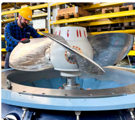
Fot. 3. Od lewej: montaż warsztatowy wirnika turbiny, montaż in situ komory turbiny z wirnikiem, wpasowanie turbiny do rury ssącej
