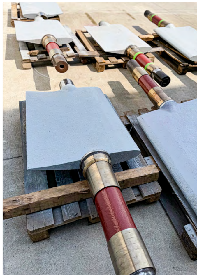
Fot. 11. Łopaty aparatu kierowniczego po remoncie
