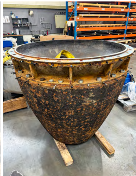
Fot. 2. Ręczne oczyszczanie wnętrza piasty wirnika, optywka turbiny przed rozpoczęciem remontu
