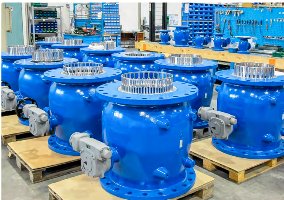
Fot. 6. Zawory iglicowe DN600 PN25 z różnymi typami cylindrów szczelinowych
