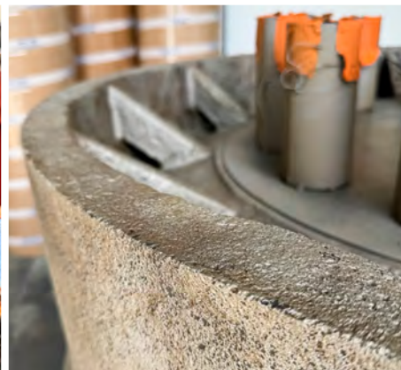
Fot. 3. Zbliżenie na wygląd powierzchni piasty przed i po oczyszczeniu strumieniowo-ściernym
