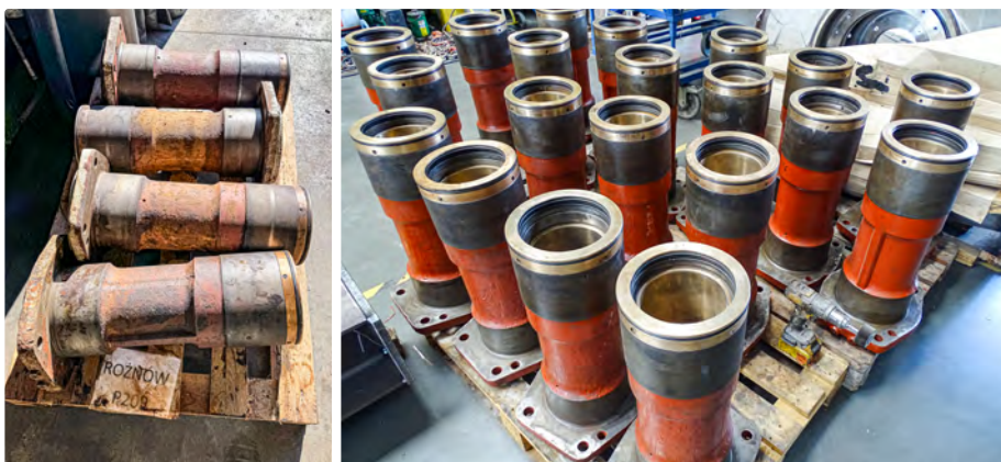
Fot. 8. Tuleje łożyskowe przed i po regeneracji
