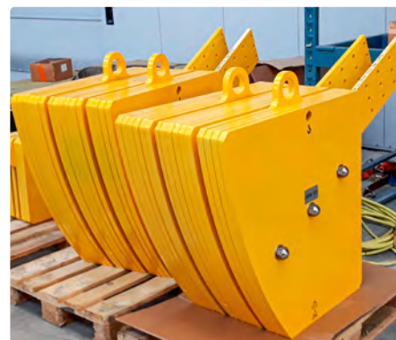
Fot. 2. Obciążniki przeciwwagi przepustnic DN2200 PN6 o indywidualnie dobranych kształtach
