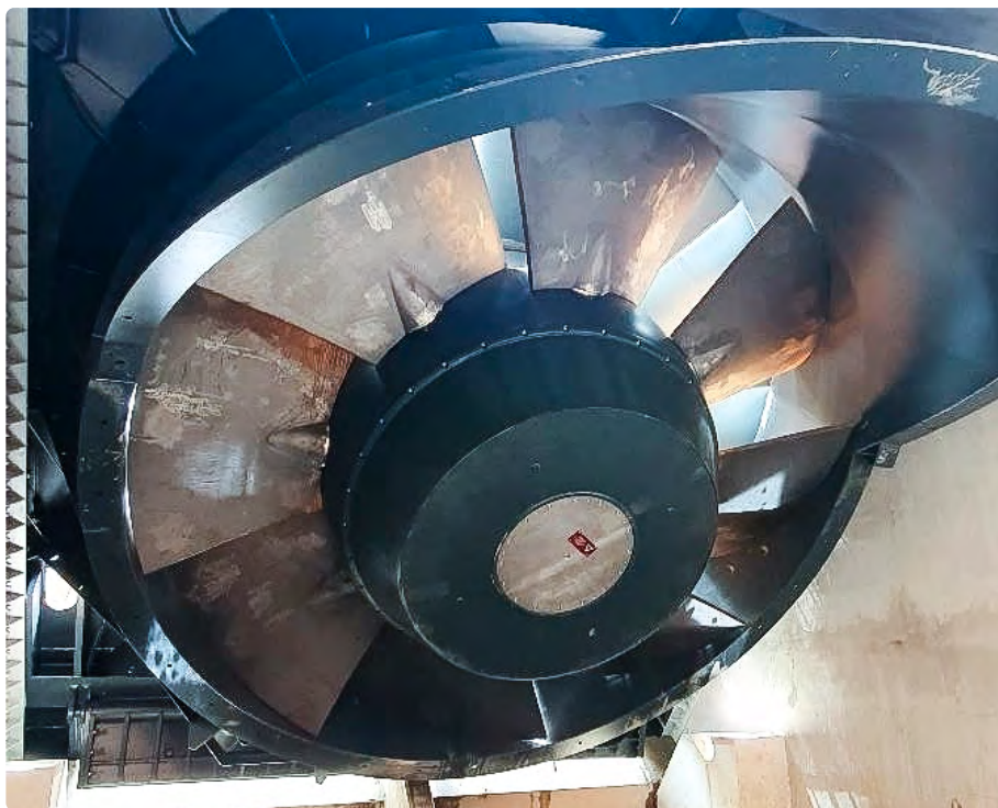
Fot. 3. Turbina VLH w pozycji roboczej
