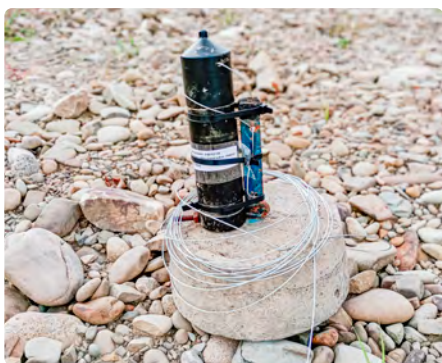
Fot. 6. Hydrofon– odbiornik i rejestrator sygnałów z nadajników akustycznych
