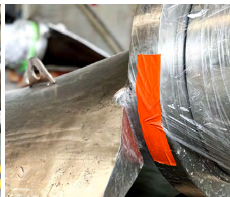
Fot. 3. Zbliżenie na wygląd powierzchni piasty przed i po oczyszczeniu strumieniowo-ściernym
