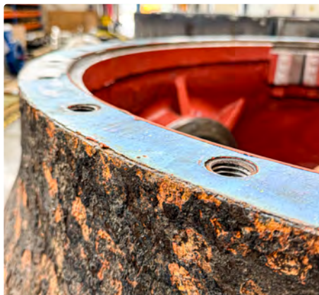
Fot. 3. Zbliżenie na wygląd powierzchni piasty przed i po oczyszczeniu strumieniowo-ściernym
