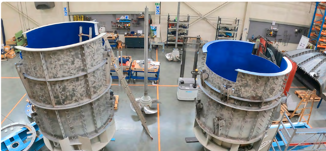
Fot. 4. Montaż nowych turbin w hali produkcyjnej
