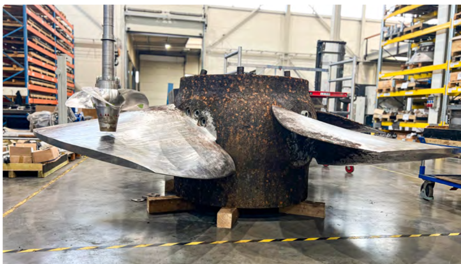
Fot. 1. Wirnik remontowanej turbiny w zestawieniu z jednym z wirników produkcji IOZE hydro (mikroturbiną IOZE rivus)
