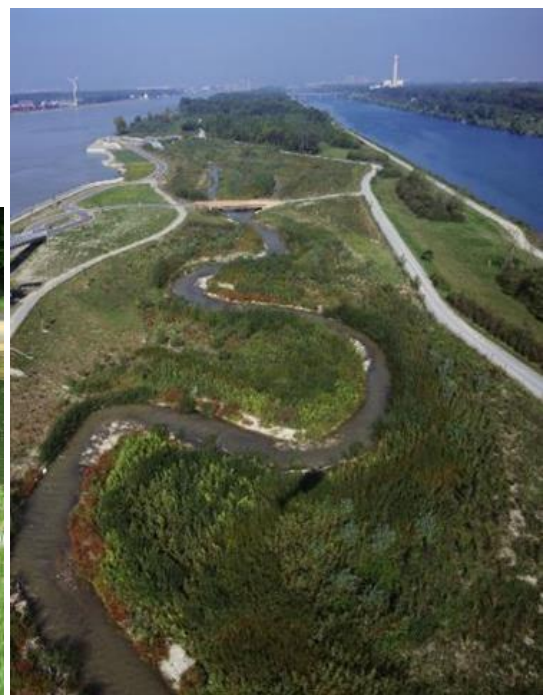
Fot. 7 Od lewej: Bystrotok; przepławka naturalna przy Elektrowni Wodnej Freudenau Źródło: po lewej – S. Babiński, po prawej – W. Reckendorfer
