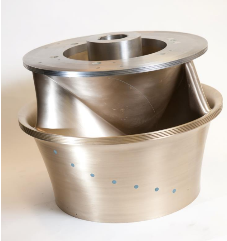
Fot. 3 Turbina Aldena Źródło: Alden Laboratory
