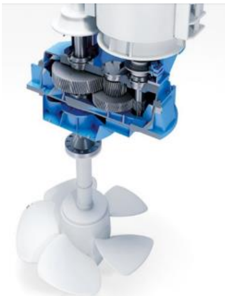
Rysunek 47: Rurowa turbina w układzie studniowym (pit turbine) z kątową przekładnią zwiększającą prędkość obrotową (Voith, lata 90. XX wieku)
