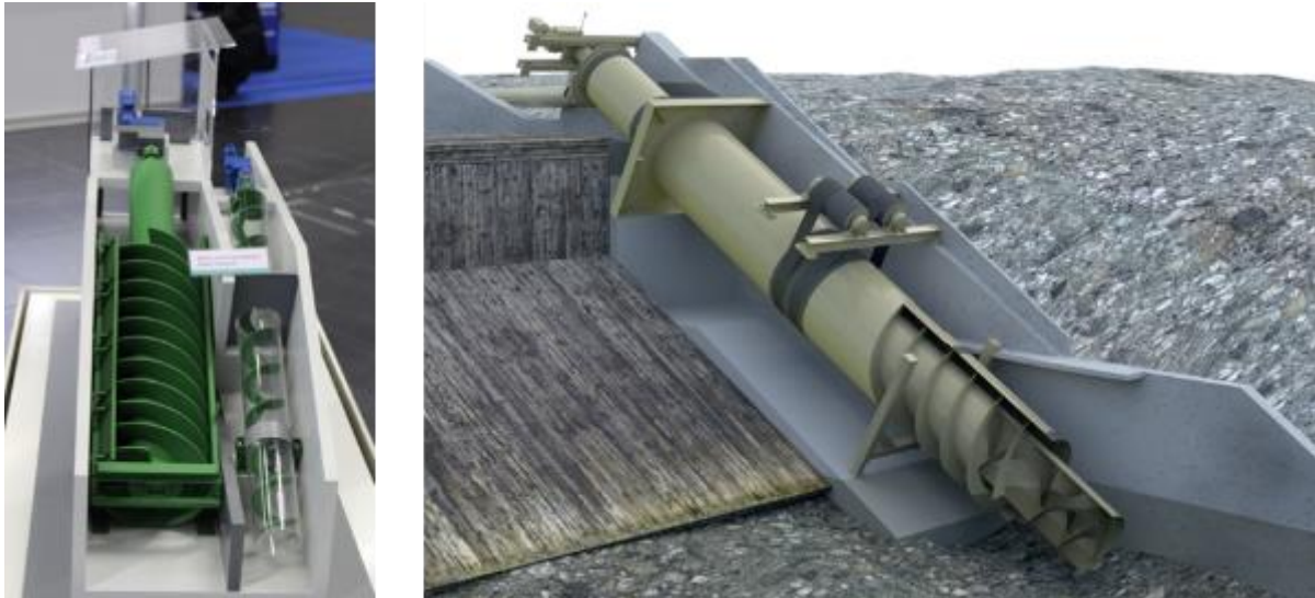
Rysunek 45: Równoległy układ śrub Archimedesesa firmy Rehart Power (po lewej) oraz trójwymiarowy widok współosiowego hydrozespołu śrubowego Hydroconnect (po prawej) prezentowanego podczas targów RENEXPO Interhydro w 2017 roku (źródło: J. Steller)
