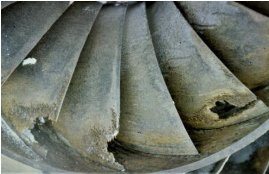
Rysunek 13: Rozległe uszkodzenia kawitacyjne na stronie ssącej wirnika małej turbiny Francisa
